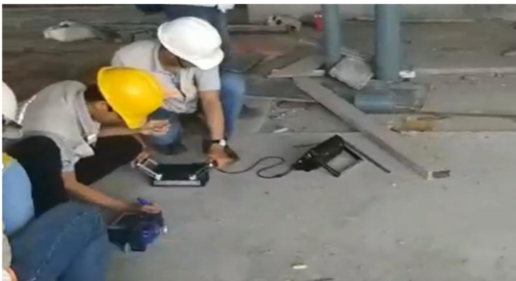
Siêu âm kiểm tra vữa bơm
